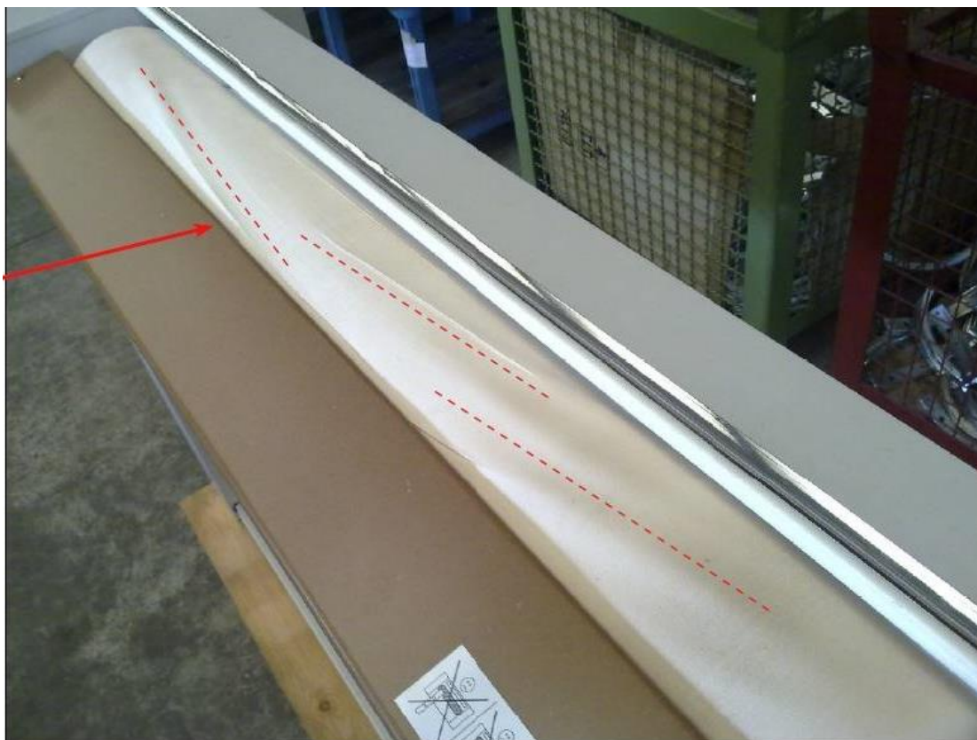
Oštećeni valjak zbog umetanja rublja samo u sredini
